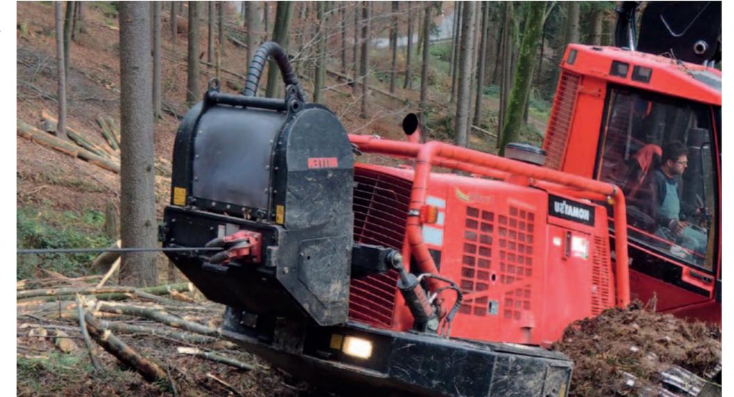
das Gewicht auf drei oder vier Achsen mit Breitreifen zu verteilen, um bei Bedarf noch Kettenbänder aufziehen zu können. Bedingt durch den technischen Fortschritt kann ein größeres Fahrzeug heute relativ bodenschonend eingesetzt werden, was vor allem am Steilhang wichtig ist.
